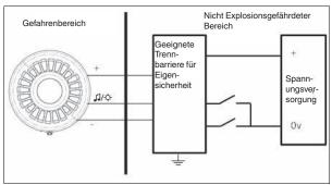
Durch Umschalten zwischen den Rückführungen für das zweistufige System wird der zweite Ton aktiviert. Den Ton für die zweite Stufe finden Sie in der Tontabelle (siehe "Tontabelle").
