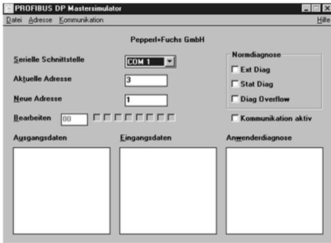
Der PROFIBUS Mastersimulator ist ein einfaches universelles Werkzeug für den Datenaustausch mit PROFIBUS-Slaves fast aller Hersteller über PROFIBUS DP. Der PROFIBUS Mastersimulator kann mit vielen PROFIBUS-Slaves auch ohne GSD-File, ohne Typdatei und ohne PROFIBUS-Master Daten austauschen. Ohne weitere Eingaben oder zusätzliche Dateien können
