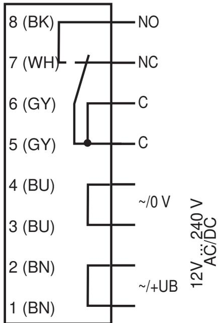
Die Relais-Funktionen "Öffner" und "Schließer" beziehen sich auf die Schaltungsart "Hellschaltung", in deren Stellung sich der Hell-/ Dunkelumschalter auf der Gehäuserückseite befindet (= Auslieferungszustand).
