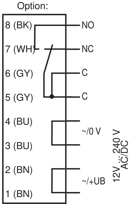
Die Relais-Funktionen "Öffner" und "Schließer" beziehen sich auf die Schaltungsart "Dunkelschaltung", in deren Stellung sich beide Hell-/ Dunkelumschalter befinden müssen (= Auslieferungszustand).
