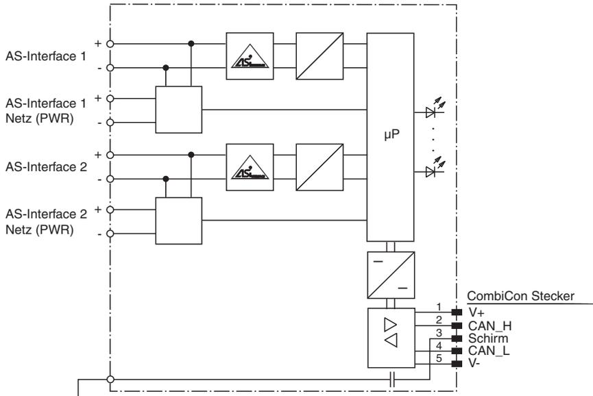
AS-Interface-Kreis 1 und 2 werden aus separaten Netzteilen versorgt. Die Versorgung des Gateways erfolgt aus Kreis 1. Am Kabel für das Netzteil dürfen keine Slaves oder Repeater angeschlossen werden. Am Kabel für den AS-Interface-Anschluss dürfen keine AS-Interface-Netzteile oder weitere Master angeschlossen werden.
