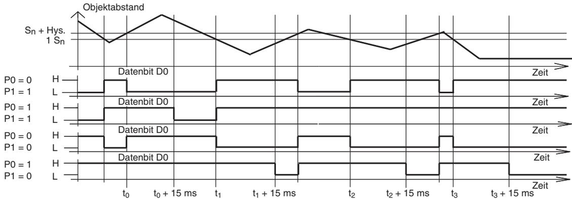
Voreingestellt ist die Ein-/Ausschaltverzögerung eingeschaltet (P0=1). Einschaltverzögerung um 15 ms, wenn P0=1 und Schließfunktion (P1=1). Ausschaltverzögerung um 15 ms, wenn P0=1 und Öffnerfunktion (P1=0).
