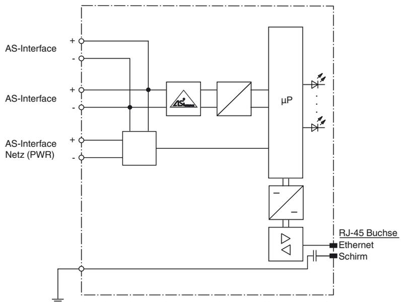
Am Kabel für das Netzteil dürfen keine Slaves oder Repeater angeschlossen werden.
