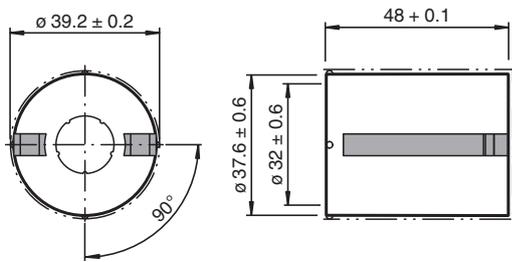
mit Distanzelement für Wellenhöhe 20 mm
