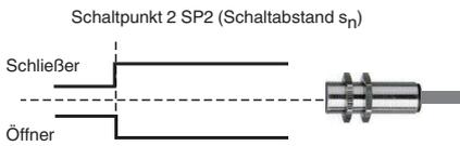
**Schaltpunktbetrieb mit nahem Schaltabstand**
