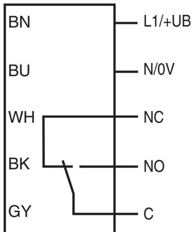
Die Relais-Funktionen "Öffner" und "Schließer" beziehen sich auf die Schaltungsart "Hellschaltung", in deren Stellung sich der Hell-/ Dunkelumschalter auf der Gehäuseoberseite befindet (= Auslieferungszustand).
