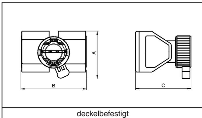
**Kontaktblöcke - Abmessungen**
