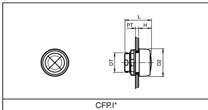
**Leuchtdrucktaster Betätigungsvorsätze - Abmessungen**
