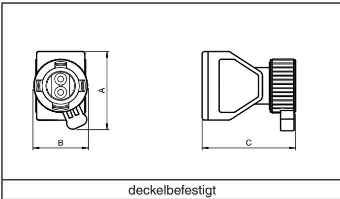
**Kontaktblöcke - Abmessungen**
