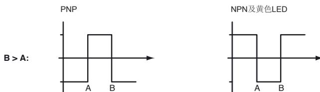
**步骤1:** 设置近点A: 将旋钮调到Q1A位置, 将光电开关光斑对准目标物, 按下Teach-in按钮(约1 s)直到绿色LED和黄色LED同时闪烁; 释放Teach-in按钮后, 绿色LED和黄色LED交替闪烁(2.5 Hz); 当绿色LED常亮, 黄色LED常亮(或常暗)时, 光电开关完成近点A设定。
