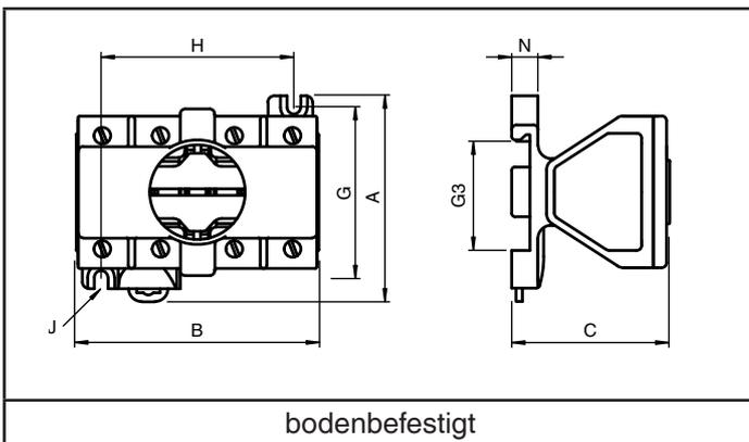
**Kontaktblöcke - Abmessungen**
