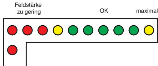
Die Feldstärke ist ausreichend, wenn LEDs im grünen Bereich leuchten. Die Feldstärke sollte über die gesamte Länge des Zylinderrohrs überprüft werden. Im Bereich des Kolbens sollte die Feldstärke am höchsten sein.
