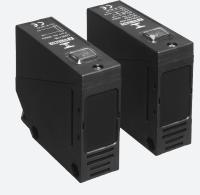
Sensor fotoeléctrico de barrera, unidireccional, rango de detección de 20 m, luz infrarroja, modo claro/oscuro activado, versión de CC, salida PNP, ajuste de sensibilidad, salida de estado previo al fallo, compartimento de bornes
