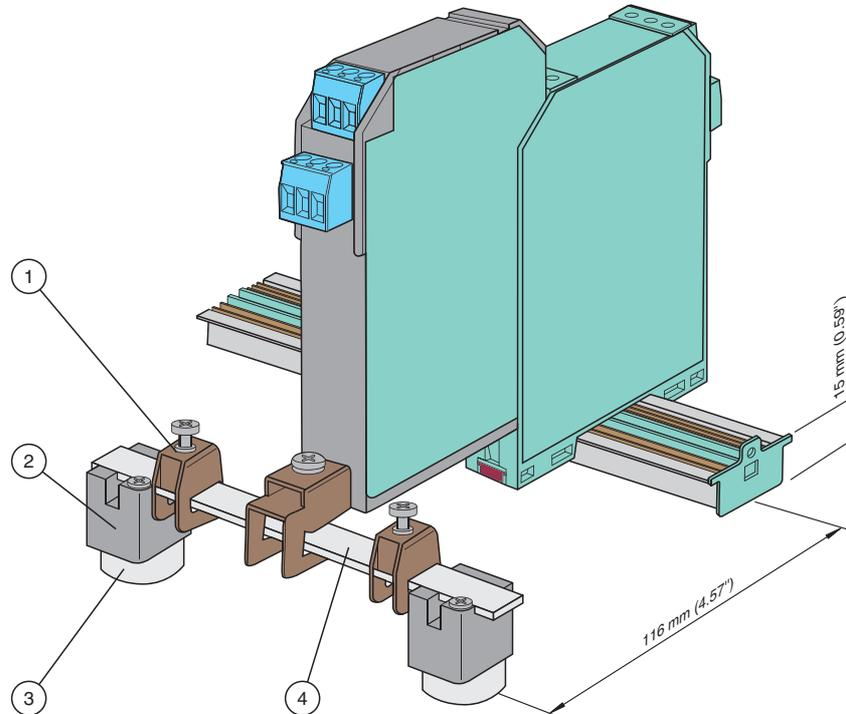
Halten Sie den Bohrabstand 116 mm zwischen Mitte Tragschiene und Mitte Erdungsschiene ein.
