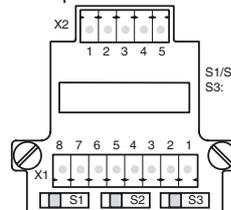
S1/S2: Verrouillage démarrage/ré démarrage
