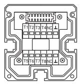
Transmisor canal 1 T2 Transmisor canal 2 0 V
