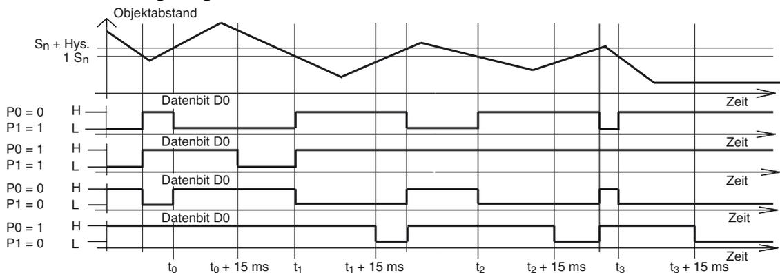
Voreingestellt ist die Ein-/Ausschaltverzögerung eingeschaltet (P0=1). Einschaltverzögerung um 15 ms, wenn P0=1 und Schließerfunktion (P1=1). Ausschaltverzögerung um 15 ms, wenn P0=1 und Öffnerfunktion (P1=0).
