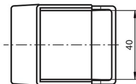
Espessura da parede = 2 mm
