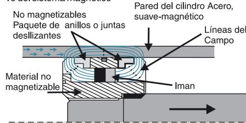
Con este sistema de sensores no sirve montar simplemente un imán permanente en el pistón. Debe construirse un sistema magnético que introduzca con precisión el flujo magnético de los imanes permanentes en la pared del cilindro, para alcanzar así una imantación muy elevada. Los detalles para la construcción de un sistema magnético están descritos en el manual. Antes de cualquier aplicación en serie se recomienda un ensayo general práctico!
