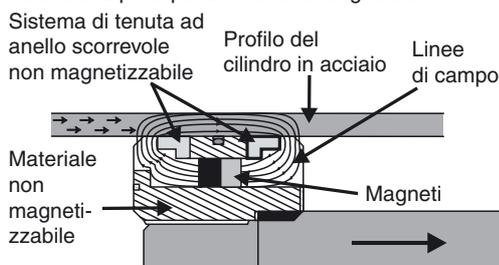
Nel caso di questo sensore non è sufficiente applicare semplicemente un magnete permanente al pistone.
