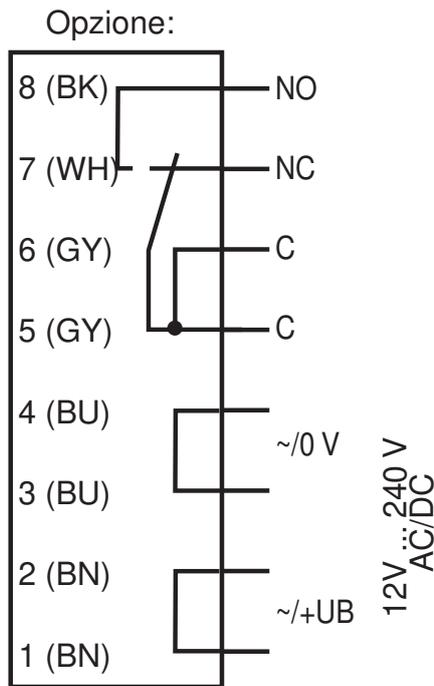
Le funzioni del relè "contatto di riposo" e "contatto normale aperto" si riferiscono alla configurazione circuitale "unblanking", nella cui posizione si trova il commutatore unblanking/blanking nella parte superiore del contenitore (= condizione in fase di consegna).
