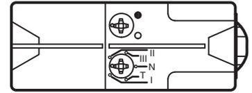
È possibile passare direttamente da un livello di riconoscimento del contrasto all'altro senza dover prima spostare di nuovo il commutatore rotativo su T. Riguardo alla modalità di riconoscimento del contrasto (teach-mode) il funzionamento ausiliario deve essere impostato almeno a 2,5 (vedere la curva dell'intensità luminosa relativa di ricezione).
