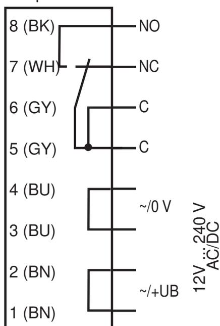
Le funzioni del relè "contatto di riposo" e "contatto normale aperto" si riferiscono alla configurazione circuitale "unblanking", nella cui posizione si trova il commutatore unblanking/ blanking nella parte superiore del contenitore (= condizione in fase di consegna).
