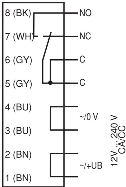
Las funciones de relé «abrir» y «cerrar» se refieren al modo de conmutación «conmutación clara», en cuya configuración se encuentra el conmutador claro/oscuro en la parte superior de la carcasa (= estado en la entrega).
