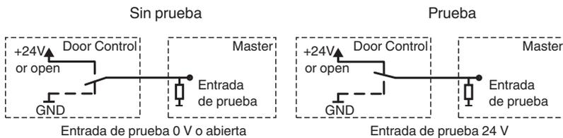
Si el dispositivo no se utiliza como sensor de seguridad conforme a DIN 18650, no es necesario conectar la entrada de prueba.
