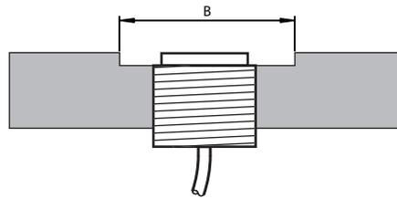
Para evitar cambios en la característica de la energía transferida, debe mantenerse la distancia específica a las paredes metálicas que sobrepasen la zona libre mínima.
