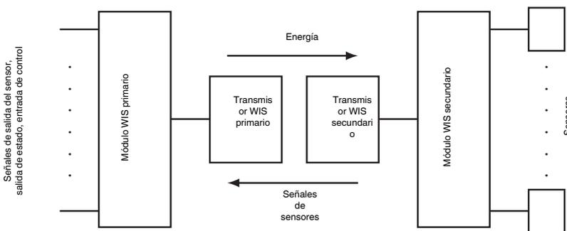
La suma de las corrientes de reposo de todos los sensores conectados al módulo WIS secundario no puede ser mayor que la corriente máxima que se puede transmitir. Ésta es igual a la potencia transmisible indicada por los transmisores / 12 V.
