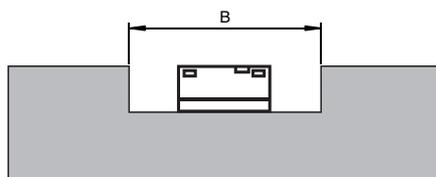
Para evitar cambios en la característica de la energía transferida, debe mantenerse la distancia específica a las paredes metálicas que sobrepasen la zona libre mínima.
