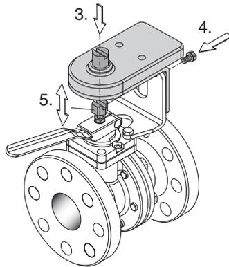
6. Monte o acionamento no eixo e o sensor duplo na placa de sensores.
