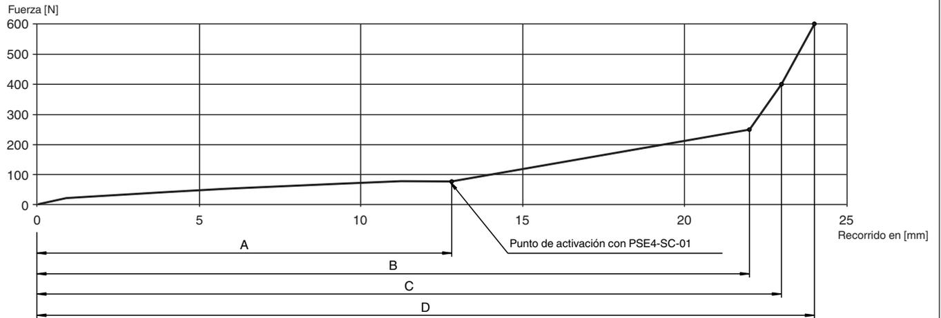
Este diagrama del recorrido de la fuerza representa la deformación del sensor cuando está sometido a carga por compresión
