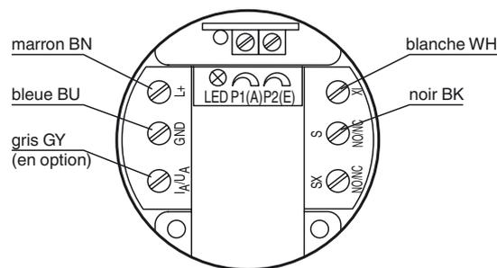
Les bornes  $I_A/U_A$  (sortie analogique) et SX (2<sup>e</sup> sortie de commutation) ne sont pas nécessaires pour la programmation.
