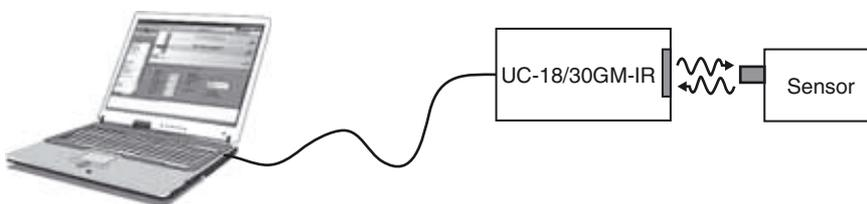
Además, para definir los parámetros del sensor, también es necesario el software de configuración de parámetros ULTRA-PROG-IR. Puede descargar gratuitamente el software ULTRA-PROG-IR desde el sitio web [www.pepperl-fuchs.com](http://www.pepperl-fuchs.com). Este software permite configurar todos los parámetros configurables, entre los que se incluyen los siguientes:
