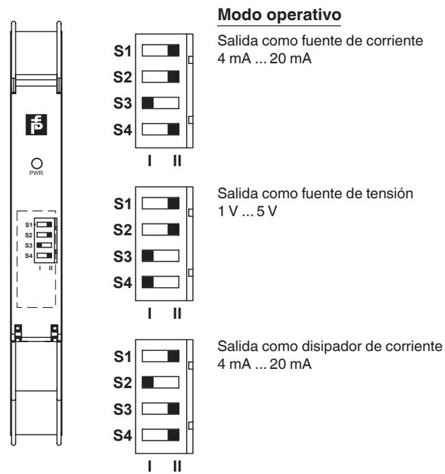
Configuración de fábrica: salida como fuente de corriente 4 mA ... 20 mA
