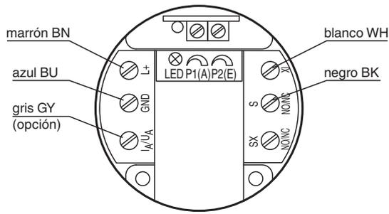
Los terminales  $I_A/U_A$  (salida analógica) y SX (segunda salida de conmutación) no son necesarios para esta programación.
