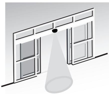
Con il potenziometro è possibile modificare l'ampiezza del campo di rilevamento.
