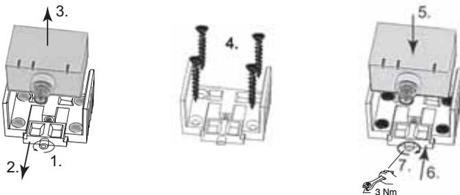
1. Lösen Sie die Zentralschraube unterhalb des Sensoranschlusses.
