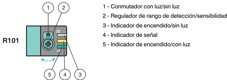
Para desbloquear las funciones de ajuste, gire el regulador de rango de detección más de 180 grados.
