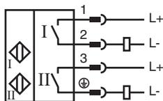
⚠ El pin caracterizado con ⊕ se utiliza como conexión de sensor y no puede conectarse con un conductor PE.
