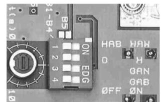
Utilice el potenciómetro situado a la izquierda de los interruptores para ajustar los valores continuos de GAN y GAB de 0,1 s a 10 s.
