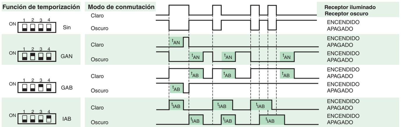
Los tiempos  $t_{AN}$ ,  $t_{AB}$  y  $t_{IAB}$  son ajustables de 0,02 a 1 segundo.
