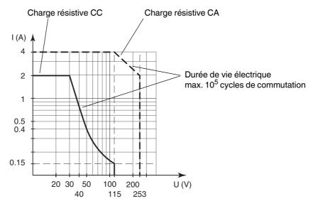
Le nombre maximum de cycles de commutation dépend de la charge électrique. Il peut être plus élevé en cas d'application de tensions ou d'intensités réduites.
