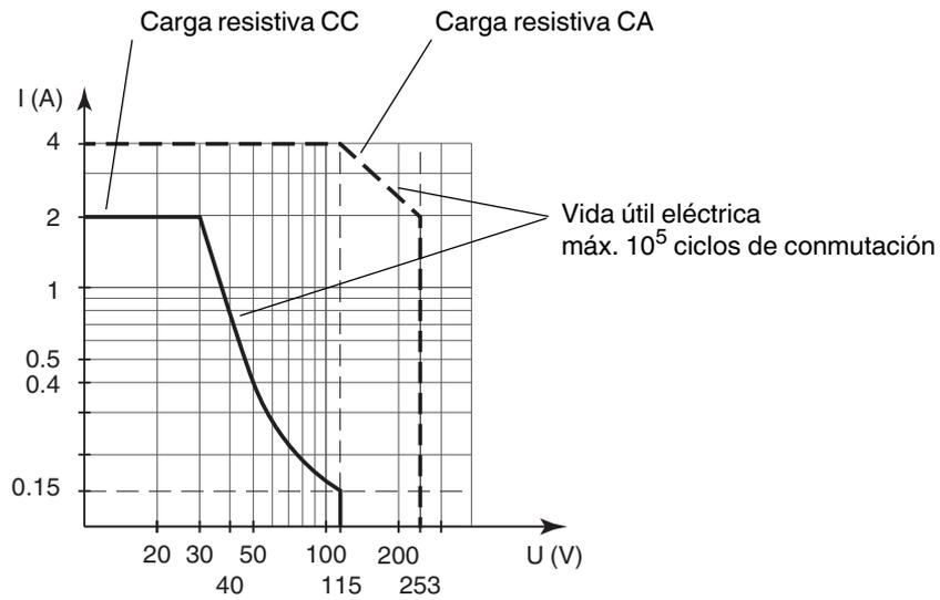
El número máximo de ciclos de conmutación depende de la carga eléctrica y puede ser mayor cuando se aplican corrientes y tensiones reducidas.
