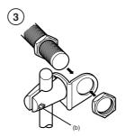
Monter les deux parties de la bride de fixation (a) provisoirement à l'aide de la vis (b) et de l'écrou (c) livrés.
