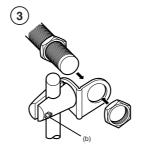
Montieren Sie die beiden Schellenhälften (a) lose mit Hilfe der beiliegenden Schraube (b) und Mutter (c). Befestigen Sie den Haltewinkel (d) und ziehen Sie anschließend die Schraube (b) soweit an, dass sich der Winkel noch drehen lässt.
