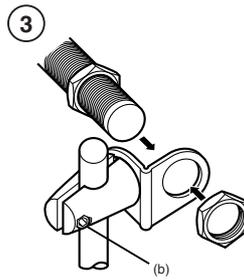
Apriete el tornillo (b) según el montaje y alineación del sensor.
