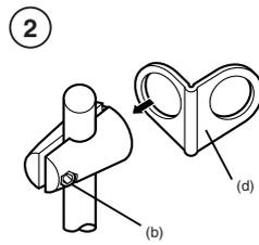
Fije la abrazadera de montaje (d) y apriete a continuación el tornillo (b) de tal forma que se pueda girar el ángulo de sujeción.
