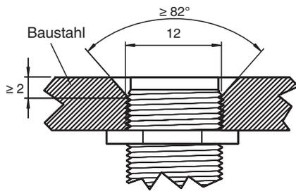
Sensordfläche bündig mit Einbauebene.
