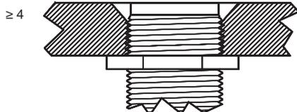
Superfície do sensor embutida no nível de montagem.
