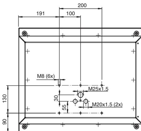
Bodenansicht Monitorgehäuse für 15"- und 19"-VisuNet-EX1-Panels
