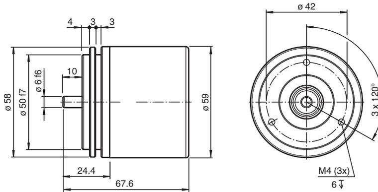
Servoflansch bei Kabel und Stecker M12, M23 (axial)
